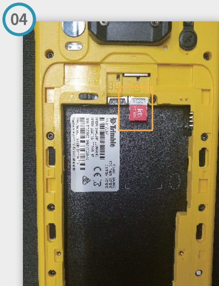
04 USIM설정 장비 뒷면 배터리 탈착후 화면과 같이 USIM 삽입
