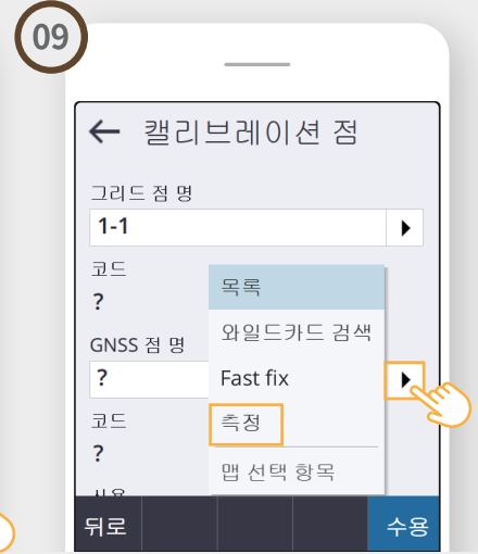
측정할 기준점 이동 후 GNSS 점 명: [▶] 화살표 선택 후 [측정] 선택
