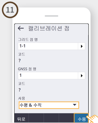
• 그리드 점 명과 GNSS 점 명 확인 • 사용: 수평&수직 선택 [수용] 선택
