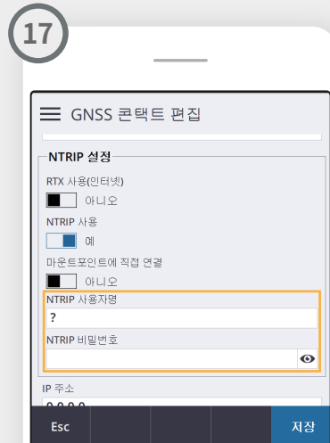
17 [NTRIP 설정] • NTRIP 사용자 명 국토지리정보원에서 가입한 네트워크 서비스 아이디 입력 • NTRIP 비밀번호 ngii 입력 (공통 비밀번호)
