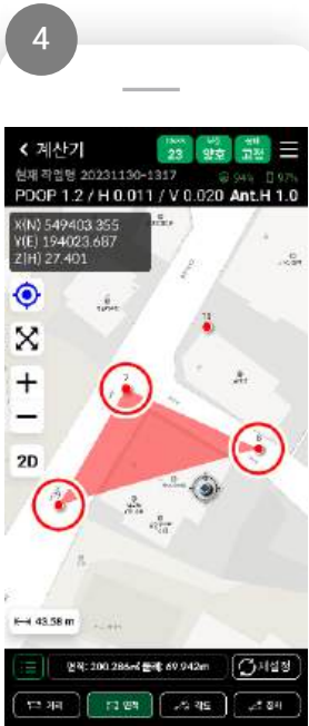
[면적] 선택 후 면적 계산할 포인트 (3점 이상) 선택 - 면적과 둘레 계산
