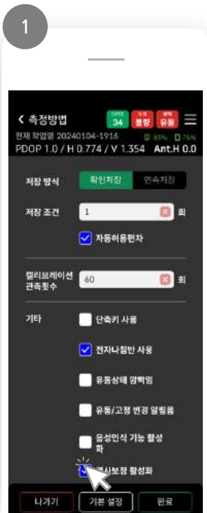
[경사보정 활성화] 클릭 틸트센서를 지원하는 장비일 경우, 수신기에 내장된 기울기 센서를 사용
