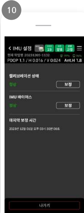
자력계 캘리브레이션이 완성 되면 IMU 바이어스 정상 표시
