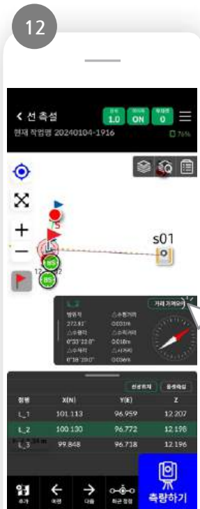
측설 점 선택 후 [거리 가져오기] 클릭 △수평거리, △수직거리, △사거리 확인
