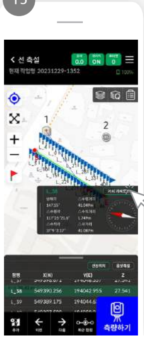
측설 점 선택 후 [거리 가져오기] 클릭 - 측설선의 좌우 오프셋으로 측설점이 생성됩니다.
