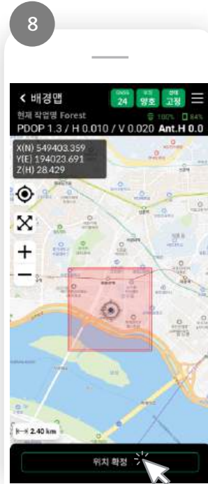
지도에서 범위를 설정, 범위 영역은 1제곱킬로미터이며 해당 영역은 고정으로 배경맵의 위치를 조정하여 원하는 위치의 영역에 현재 위치를 설정한 후 [위치 확정] 클릭
