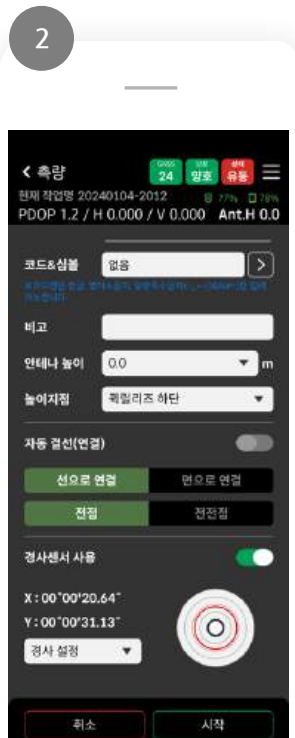
[측량] - [경사센서 사용] 수신기에 내장된 기울기 센서를 사용하여 경사측정
