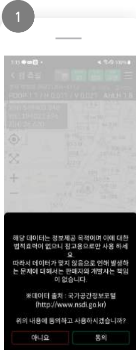
[지적도근점] 클릭 후 [동의] 클릭 - 지적도근점은 Bessel(TM) 좌표계만 지원합니다.
