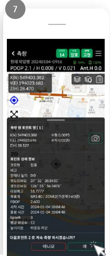
해당 포인트 측량이 정상적으로 실행되고 난 후 해당 포인트에 대한 현장사진 촬영 및 상세정보 확인 가능 - 계속 측량을 원할 경우, 다음 포인트로 계속 측량 “예” 클릭
