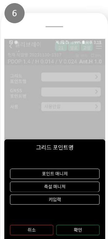
- [포인트 매니저] : 측정된 포인트 입력 - [측설 매니저] : 측설점 입력 - [키입력] : 직접 좌표 입력
