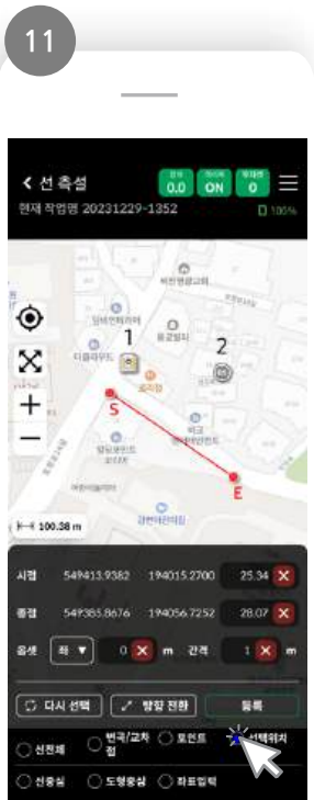
[선택위치] 측량 점 선택 후 선으로 이을 2개의 점 등록 및 측정 간격 설정
