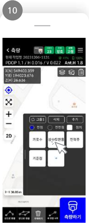
여러 개의 코드로 코드 측량 - 코드는 여러 코드를 사용 하며, 결선은 미적용합니다.
