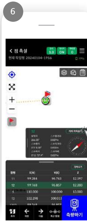
6 [거리 가져오기] 클릭 후 \Delta 수평거리, \Delta 수직거리, \Delta 사거리 확인
