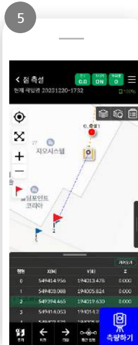
5 측설점을 선택하면 장비와 파란선으로 연결되며, 장비가 시준하는 방향은 점선으로 표시됨
