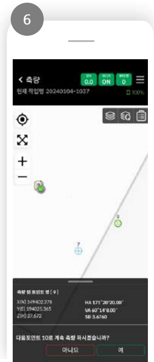
6 측량 결과 - X(N), Y(E), Z(H) 값 HA(수평각), VA(수직각), SD(사거리) 측량결과 확인
